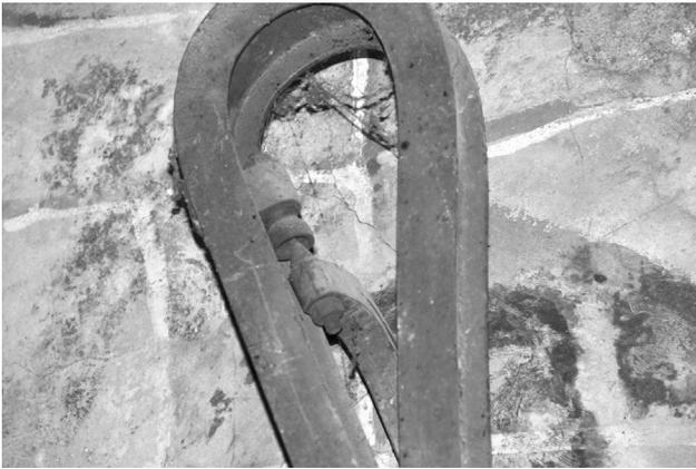
Perno superiore dell'asse di rotazione del pendolo nel Sotterraneo di Quarto
