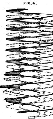
aperto, scorrevole, in filo di ferro. Ai dischi corrispondono delle sporgenze che appaiono a spirale lungo la colonna, il nucleo è regolabile. I dischi sono collegati tra loro uno si uno no . Il primario è costituito dai dischi dispari, il secondario da quelli pari Si potevano connettere colonne in serie o in parallelo.
